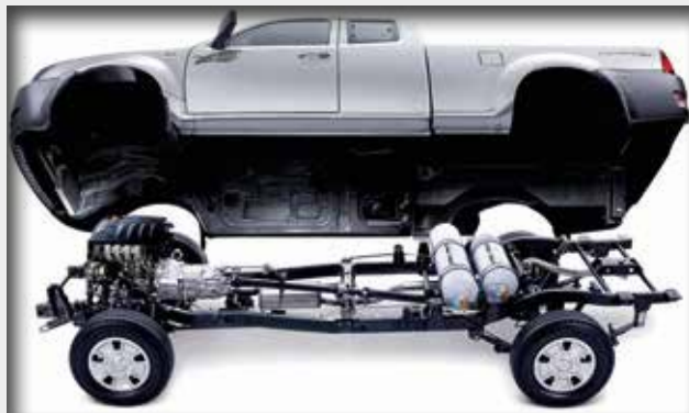
รูปที่ 5-2 ตัวอย่างรถยนต์ใหม่ที่ติดตั้งระบบก๊าซเพิ่มเติม
