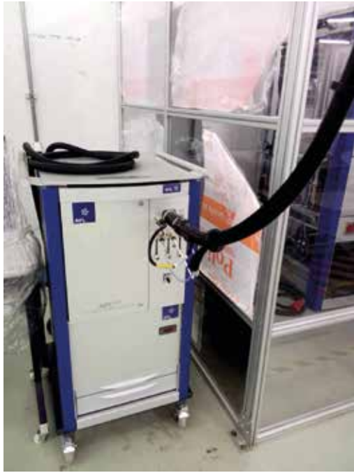
รูปที่ 6-6 ระบบเครื่องมือตรวจวัดจำนวนอนุภาคของฝุ่นละอองจากไอเสียรถยนต์ (PN Counter)
