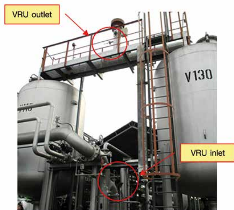
รูปที่ 3-10 จุดเก็บตัวอย่างไอระเหยน้ำมันเบนซิน ก่อนเข้าและหลังออกระบบ VRU ด้วย Tedlar bag
