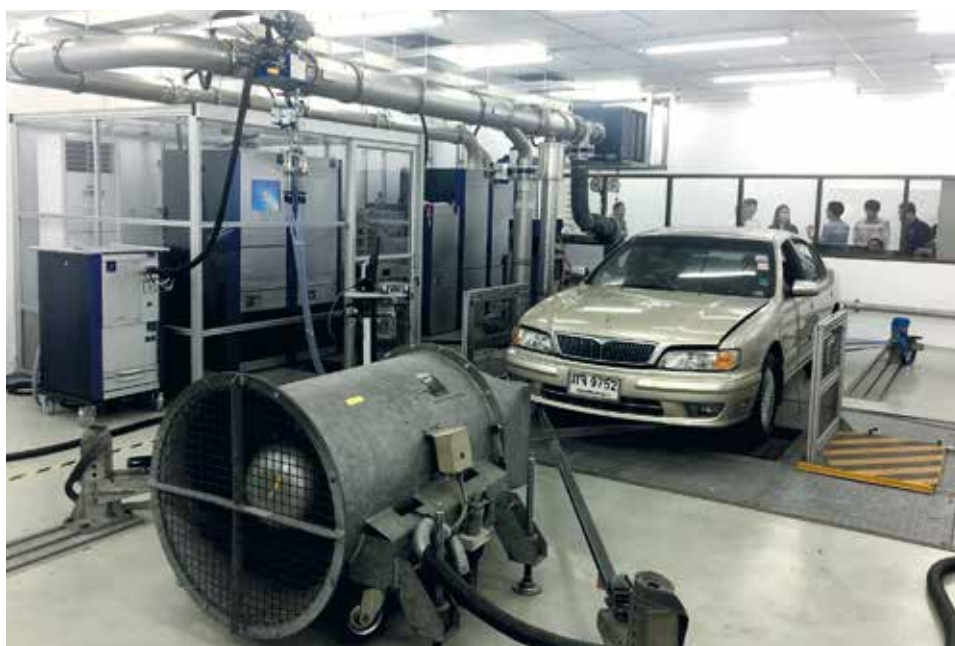
รูปที่ 6-5 ระบบเครื่องมือทดสอบมลพิษจากรถยนต์เครื่องยนต์จุดระเบิดด้วยประกายไฟ และรถยนต์เครื่องยนต์ที่ใช้จุดระเบิดด้วยวิธีใช้การอัด มาตรฐานระดับยูโร 4 - ยูโร 6
