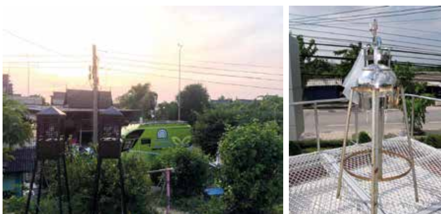
รูปที่ 1-8 แสดงการตรวจวัดปริมาณก๊าซ CS_2 ในบรรยากาศ
