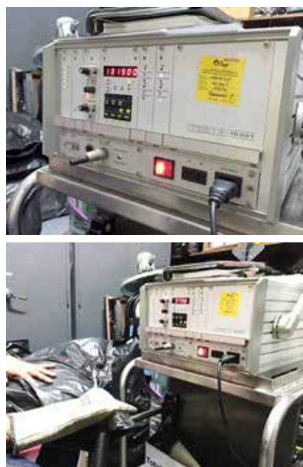
รูปที่ 3-11 การวิเคราะห์ Total VOCs ด้วยระบบ FID : Method 25A
