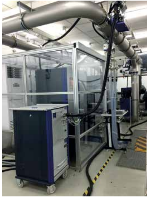
รูปที่ 6-6 ระบบเครื่องมือตรวจวัดจำนวนอนุภาคของฝุ่นละอองจากไอเสียรถยนต์ (PN Counter)
